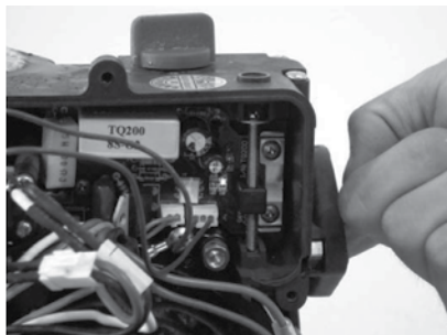
obr. C - vyzkoušení funkce zvedáním a spouštěním zpětného ventilu
